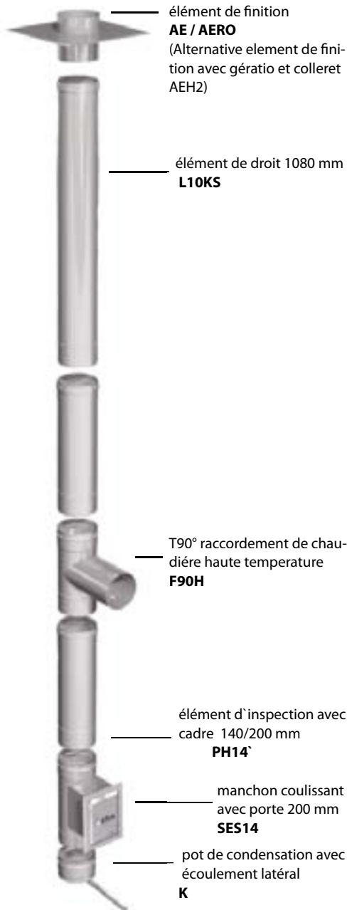
Les éléments droits L10 ont une longueur de 1000 mm. Les éléments plus courts sont disponibles, L5 (longueur utile de 460 mm) ou L3 (longueur utile de 280 mm). D'autres dimensions sont possibles par l'utilisation d'éléments à doubles manchons re-coupables. Le tronçonnage du conduit ne peut s'effectuer qu'avec un outil approprié muni d'un disque inox. Par principe tous les éléments du système sont adapté en milieu humide.
